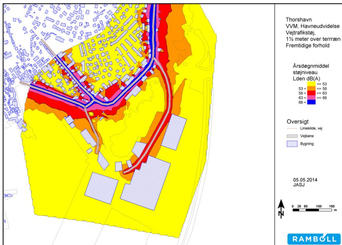
Figur 75: Vejtrafikstøj 1½ meter over terræn, Fremtidig forhold
