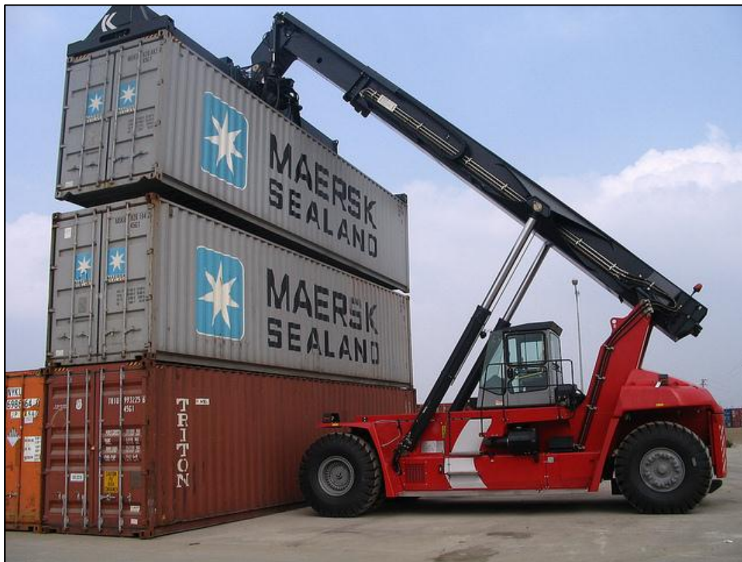
Figur 79 Eksempel på reach stacker der anvendes til flytning af containere på havnearealet
