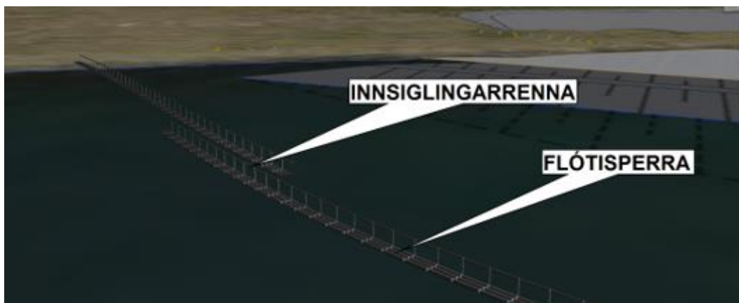
Mynd 5. Mynd av plastsperru við innsiglingarrennu
