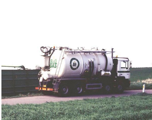
Figur 3. Lastvognsslamsugere på henholdsvis 30 og 20 ton last. Foto: Torkild Birkmose, AgroTech
